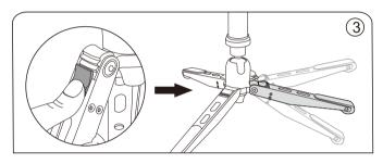
3. Push the block to adjust the mini leg angle.
