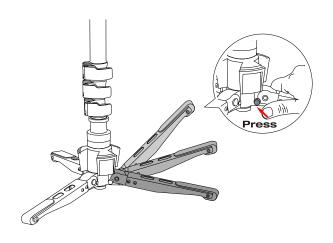
6 Press the block to adjust the mini leg angle.
